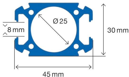
Le design de la section profilée **PPS SQ** comprend une rainure permettant d'utiliser les accessoires (écrous,...) **compatibles avec les profilés les plus courants du marché.**
