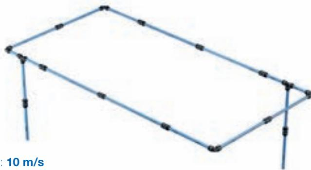
Pression : **8 bar** | Perte de charge max. **5% (0,4 bar)** | Vitesse max. : **10 m/s**
