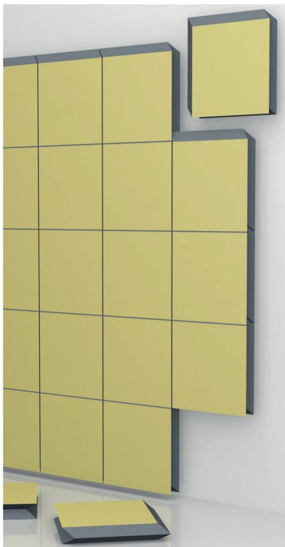
La technologie Mag Shield permet l'assemblage temporaire ou définitif des modules de protection biologique par magnétisme. Ces modules sont très flexibles et positionnables à l'aide d'un outil de manutention par ventouse afin d'éloigner l'opérateur du point chaud à protéger.
