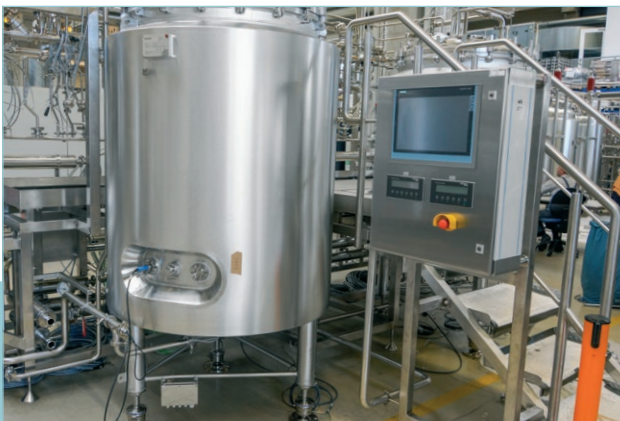
L'installation du module de pesage s'est faite en simple grâce au réglage intégré de la hauteur du Novego.
