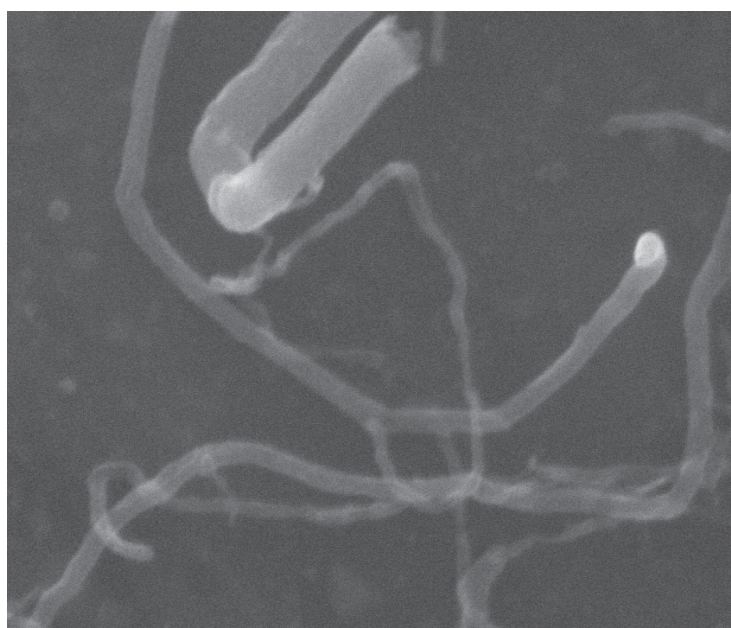
MEB conventionnel Tungstène Multiwall Carbon nanotubes 10 kV SE image à 100.000x
