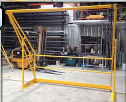
Barrière adaptée aux plafonds bas
