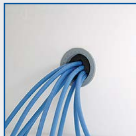
Passage de cuve Ø 30mm pour caractérisation/ qualification sur site, positionné sur la porte à 1/3 du haut.
