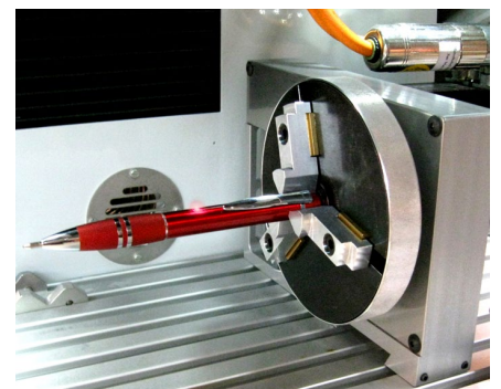
Rotary device pour le marquage de pièces cylindriques
